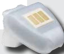
Une station météo GPS KNX. Elle mesure la température extérieure, la vitesse du vent et la luminosité. Elle détecte la pluie et la nuit. Grâce au signal GPS, elle reçoit la date et l'heure ainsi que les informations de localisation du site d'implantation
