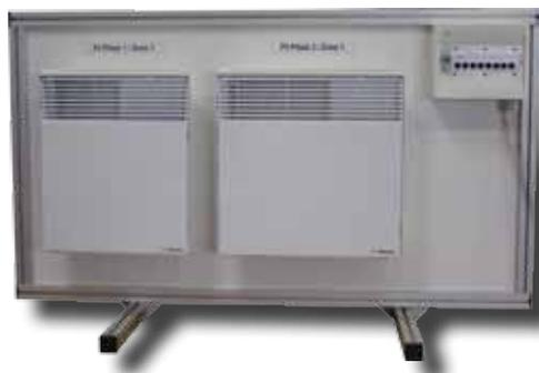
Le panneau est composé de deux faces équipée chacune de deux convecteurs (1 de 1000W et 1 de 750 W) avec fil pilote 4 ordres et un transformateur de courant pour la mesure de la consommation électrique.
