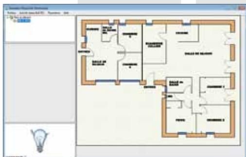
DaliSim est un outil dédié à la simulation de luminaires sur un réseau Dali existant. En conjonction avec l'interface matérielle Usb-DaliSim, il permet de mettre au point l'application développée sur le maître réseau sans être obligé de disposer des luminaires réels. Il peut également simuler des défauts sur les luminaires permettant, par exemple, de valider le comportement de l'application de GTC/GTB.
