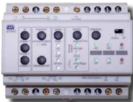
Aujourd'hui, les compteurs électroniques sont incontournables dans les installations électriques en tarif bleu. Ils délivrent des informations exploitables directement par des appareils qui optimisent la consommation et l'abonnement (ex. : contacteur J/N, délesteur, gestionnaire d'énergie, indicateur de consommation, ...). Pour cela, ils sont équipés de 2 contacts libres de potentiel et d'une sortie télé-information numérique.
