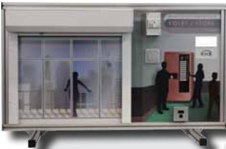
Le panneau est composé d'un volet roulant électrique, d'un module de gestion de store et volet, d'un bouton poussoir KNX pour volet. Il doit être raccordé systématiquement avec le panneau d'éclairage qui contient l'alimentation KNX ainsi que le module d'interface de programmation.
